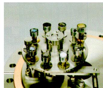
ターンテーブル(試料10個可能)に、既に試料がのっていると、庫内で落ちる原因となります。ターンテーブルに何も入っていないことを**目視で確認**してから、試料を入れるようにしてください。PCモニター横に照明のスイッチがあるので、点灯して確認をしてください。
