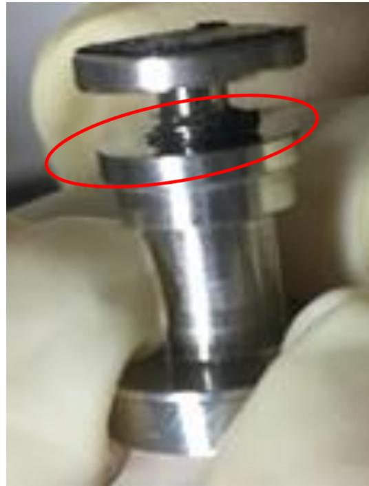
ローテーションをONにすると、試料が回るので、この時に少し振動します。その振動によりネジが下に下がってくるのを防ぐため、ネジの隙間にカーボンテープを使用する方法もあります。
