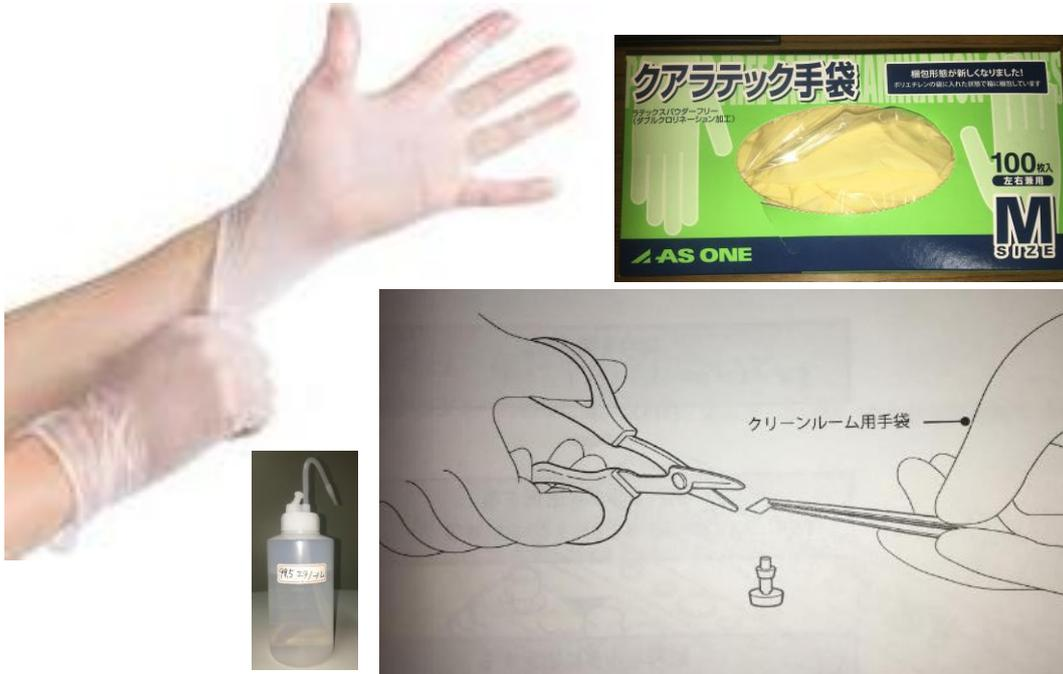
試料ホルダは素手で触らずに、手袋を使って操作をしてください。
