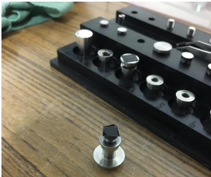
粉末試料の場合はカーボンテープに貼付して測定をしてください。ブロアー等を使用して落ちる粉はしっかりと落としてから測定してください。
